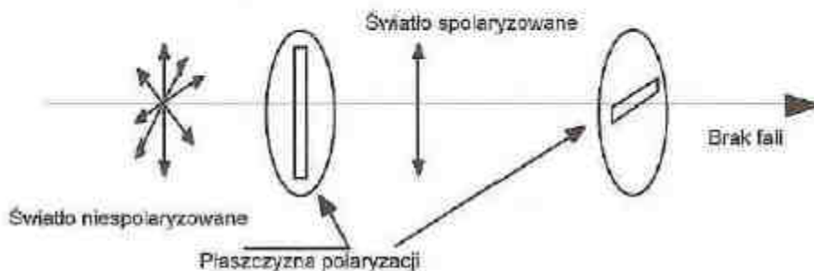
Rysunek 2.8. Oddziaływanie na światło filtrów polaryzujących
