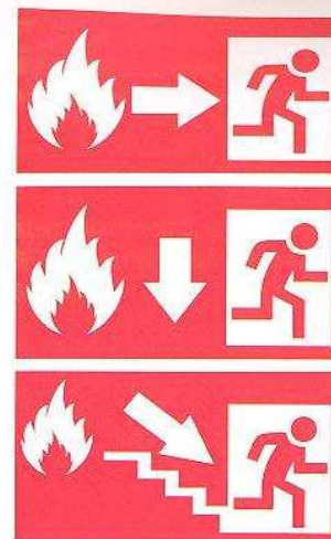
Rys. 27.1. Przykładowe oznakowanie drogi ewakuacyjnej
